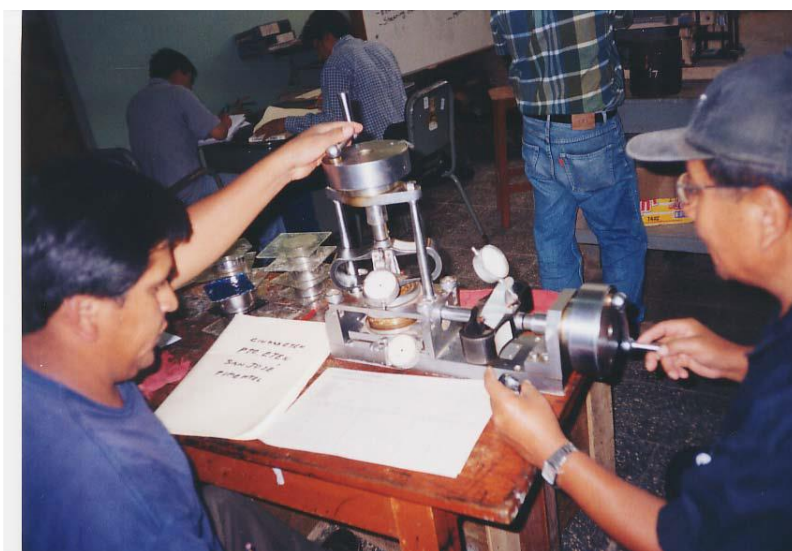
Ensayo de Corte Directo
