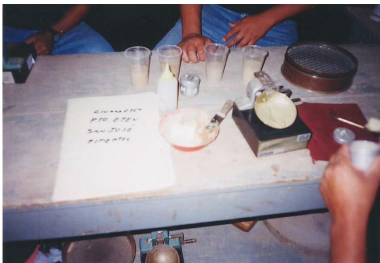
Ensayo de límite líquido
